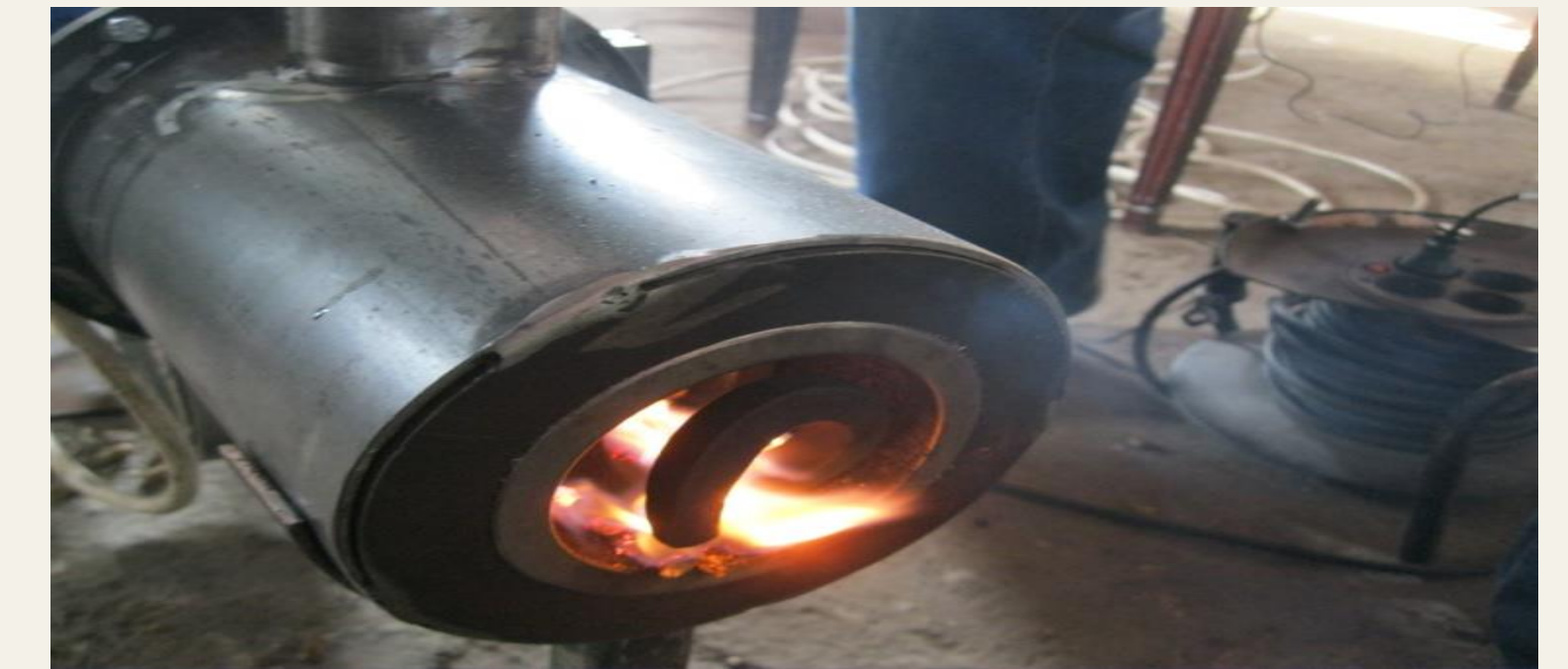
Fig 4. Testarea unui arzător pentru pelete cu flacără orizontală, cu corpul răcit cu apă
